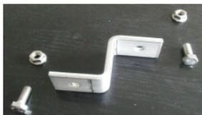
Die Z-Haken werden jeweils mit zwei Skt.-Schrauben M8x20 und Skt.-Mutter M8 mit Sperrverzahnung befestigt. Es ist zu empfehlen die Skt.-Schrauben / pro Schiene vorab in die Alu-Schienen einzuführen und auf die ungefähre Position der Dachhaken zu verteilen.
