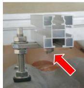
Befestigen Sie die Alu-Schienen "Profi" oder "Light" (in unterer Führungsschiene) mittels Skt.-Schraube M10x25 und Skt.-Mutter M10 mit Sperrverzahnung an das Adapterblech. (2 Profil-Schienen pro Modulreihe)
