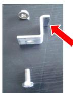
Die Modulendwinkel (Z-Winkel) sollten bereits vorab mit Skt.-Schraube M8x20 und Skt.-Mutter M8 mit Sperrverzahnung vormontiert werden. Des Weiteren muss ein EPDM-Gummi eingeklebt werden. (siehe Pfeil)
