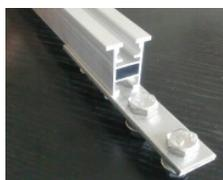
Zur Verbindung der Schienen montieren Sie einen 4-loch-Verbinde mittels vier Skt.-Schrauben M10x25 und Skt.-Mutter M10 mit Sperrverzahnung. Zur leichteren Montage können Sie die Schienenverbinder bereits vormontieren. **Lassen Sie zur Längenausdehnung zwischen den einzelnen Schienen ca. 1cm Abstand.**
