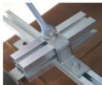
Bei einer waagrechten Modulbefestigung auf Sparrendächern muss eine Unterkonstruktion im Kreuzverbund montiert werden. Hierzu werden die Alu-Schienen mittels Z-Haken montiert. Die obere Schienenlage ist immer Alu-Schiene "Profi", die untere Lage entnehmen Sie bitte Ihrem Lieferschein.
