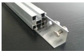
Zur Verbindung der Alu-Schienen "Profi" montieren Sie einen Alu-Verbinde L-Winkel mittels vier Skt.-Schrauben M10x25 und Skt.-Mutter M10 mit Sperrverzahnung. Zur leichteren Montage können Sie die Schienenverbinder bereits vormontieren. **Lassen Sie zur Längenausdehnung zwischen den einzelnen Schienen ca. 1cm Abstand.**
