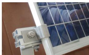
Am Anfang und Ende jeder Modulreihe wird der Modulendwinkel (Z-Winkel) seitlich bündig an die Schienen angebracht und mit der vormontierten Skt.-Schraube M8x20 und der Skt.-Mutter M8 mit Sperrverzahnung befestigt.
