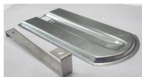
Für Dächer mit Biberschwanzeindeckung, werden je Dachhaken eine Metalldachplatte mitgeliefert. Diese wird am Montagepunkt des Dachhakens gegen die Originaldachplatte ausgetauscht und zusammen mit dem Dachhaken mittels einer Tellerkopfschraube M8x80 befestigt.
